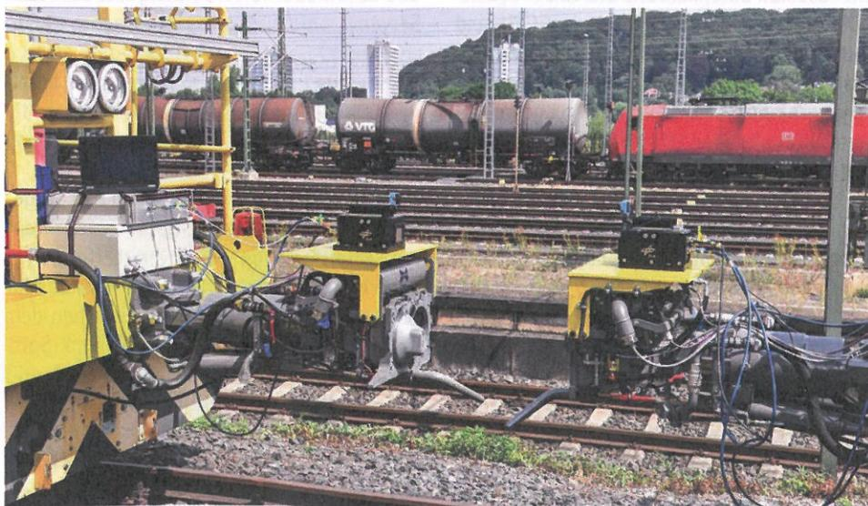
Das automatische Kuppeln von Zügen und die virtuelle Verbindung einzelner Zugwaggons oder ganzer Züge ist ein wesentlicher Schritt hin zu mehr Flexibilität und Effizienz im Schienenverkehr.
