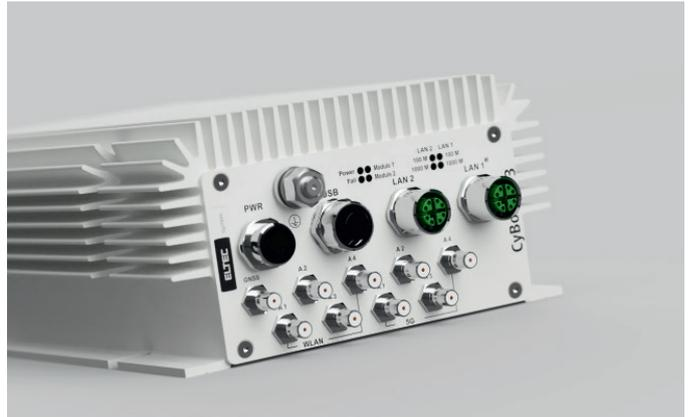
**1a/b:** CyBox RT 3-W, ein neuer robuster, wartungsfreier und nach EN 50155 zertifizierter Router für Anwendungen in der Bahntechnik
